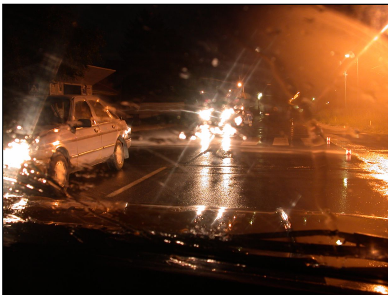
Obr.7 Podmínky, kdy nelze stanovit vzdálenost účinného dosvitu světlometů, tedy ani od něj odvozenou vzdálenost rozhledu řidiče [5]
