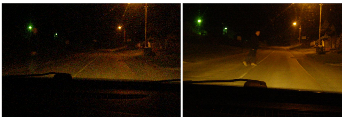
Obr.16 Vlevo je vidět téměř „neviditelný“ chodec - záběr z kamery, vpravo snímek pořízený digitálním fotoaparátem (automaticka) dokonce z větší vzdálenosti, [12]
