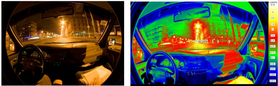
Obr.1 Nastavení sestavy – normální fotografie (vlevo), Obrázek pro vyhodnocení rozložení jasů s expozičními časy HDR 4s, 15s a 30s (vpravo)
