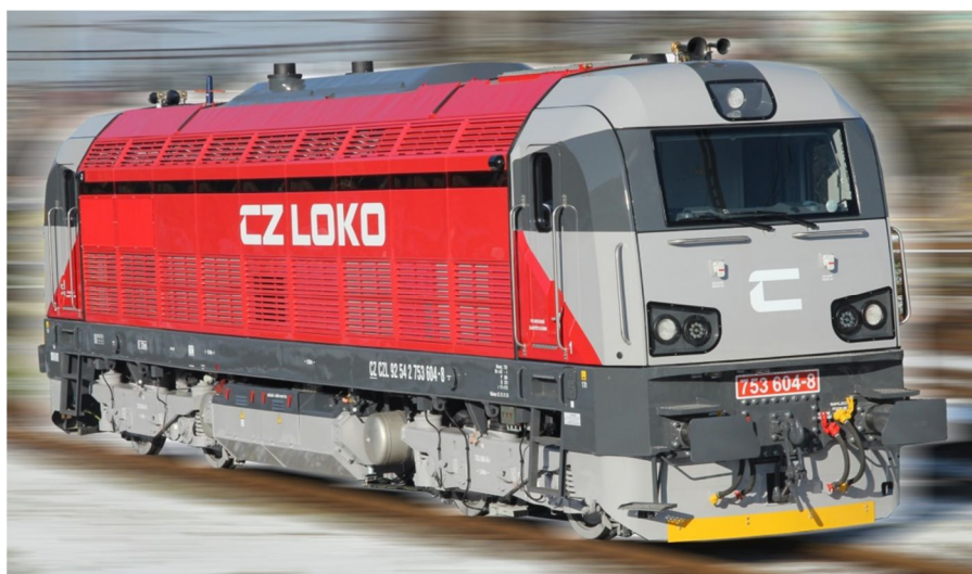
Obr.3 Lokomotiva 753-604 s novými LED světly
