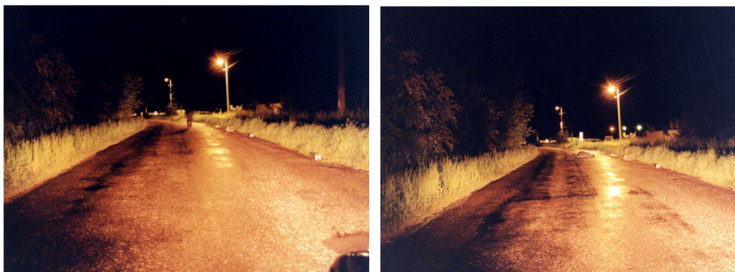
Obr.4 Vlevo stojící chodec - odstup 35 m a vpravo ležící chodec - odstup 30 m, [5]
