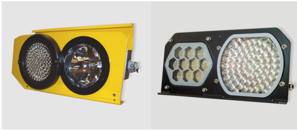
Obr.6 Světla pro 680 Pendolino. Žlutý komplet pravého spodního světla (starší) a černý komplet horního světla
