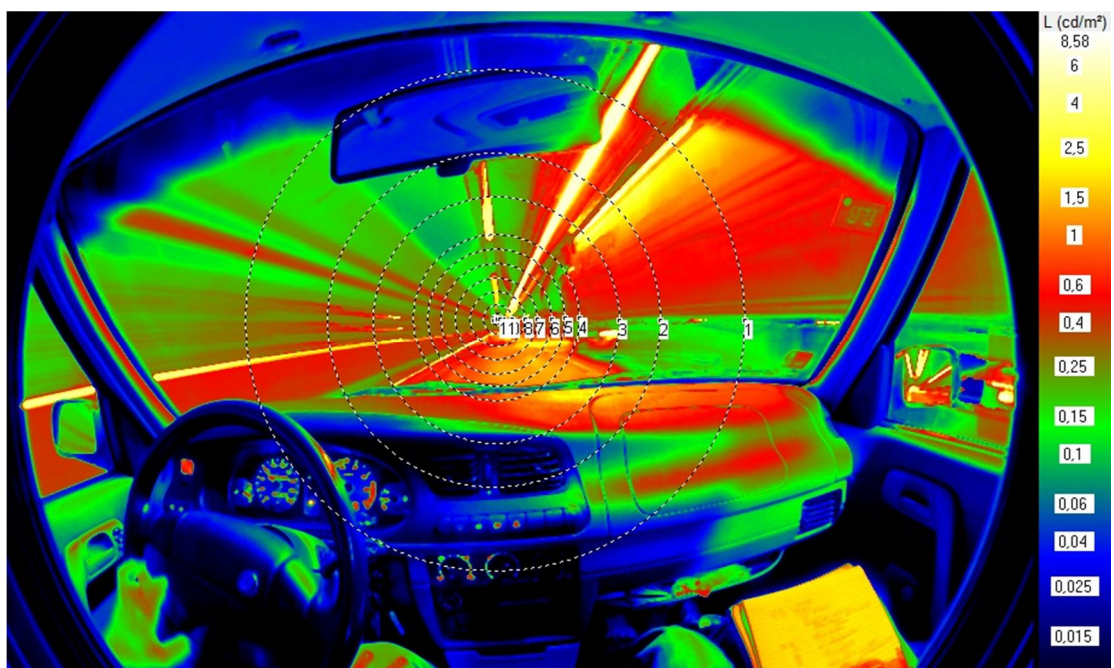
Obr.2 Měření v tunelu v pohybu v vozidle
