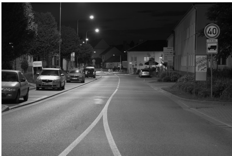
Obr. 2 Původní osvětlení komunikace – udržovaný průměrný jas je 1,5 \text{ cd}\cdot\text{m}^{-2} . Na hranici požadované hodnoty pro komunikaci třídy M2 (tehdy ME2). Jde o jiné město, než z obr. 1
