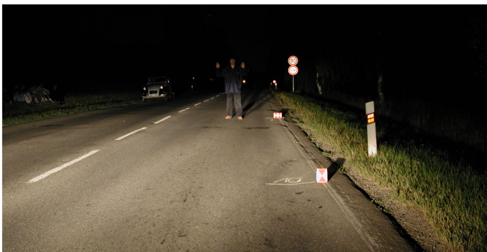
Obr.3 Uspořádání světelných bodů velmi napomáhá identifikaci tmavého chodce, [5], [12]
