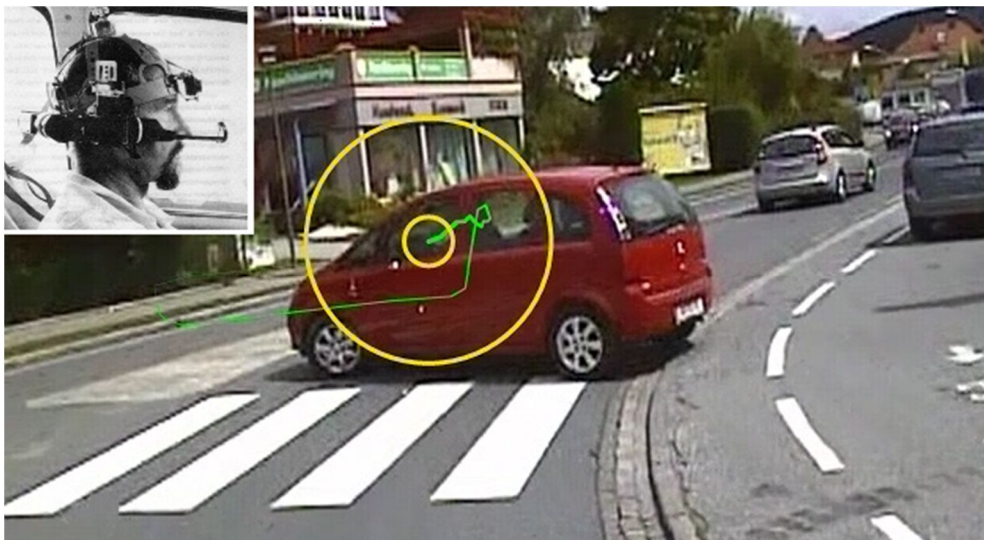
Obr.9 Systém ke zjišťování trasování pohybu oka, [11], nahoře - kamery s postrojem, [10]
